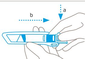
Premere il pulsante di cambio lama e rimuovere l'inserto in plastica dalla parte posteriore dell'impugnatura.
