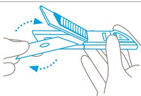
Invertire o sostituire la lama. Assicurati di posizionare la lama esattamente sul lobo di posizionamento.
