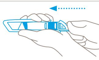
Chiudere il coperchio della lama e spingere di nuovo l'inserto di plastica nell'impugnatura finché il pulsante di cambio lama non scatta in modo udibile.
